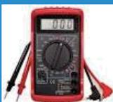
El multímetro es el equipo con el que puede medirse varias magnitudes eléctricas, incluida la tensión.
